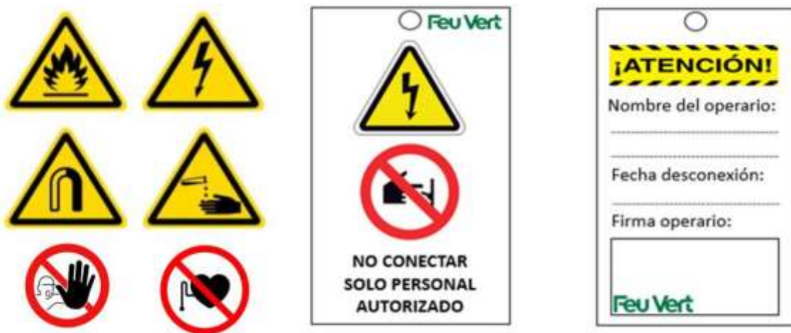
Figura 15. Señalización de advertencia y prohibiciones. Cartel identificativo del estado del vehículo. Fuente: imágenes cedidas por Feu Vert Ibérica, S.A.
