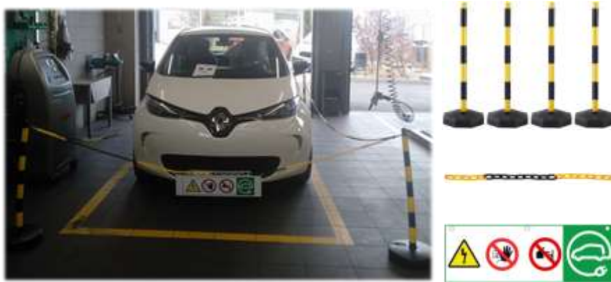
Figura 13. Elementos de delimitación y señalización de la zona de trabajo. Fuente: imágenes cedidas por Feu Vert Ibérica, S.A.
