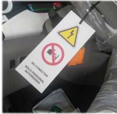
Figura 8. Colocación de tarjeta y conector de servicio en el volante. Fuente: imagen cedida por Feu Vert Ibérica, S.A.
