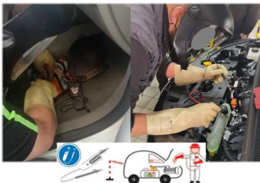
Figura 7. Comprobación de ausencia de tensión. Fuente: imágenes cedidas por Feu Vert Ibérica, S.A.
