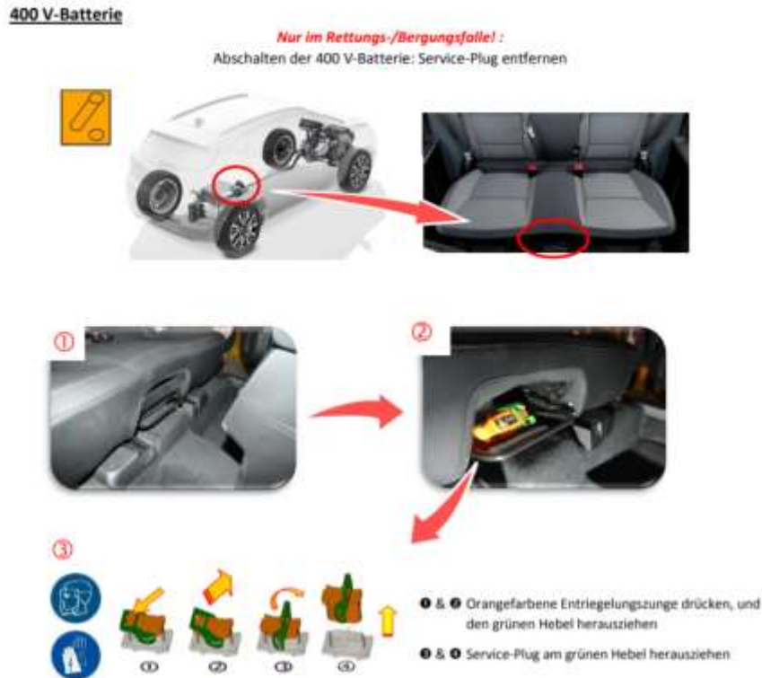
Figura 3. Ejemplo de ficha del Renault Zoe 2: Detalle de ubicación, acceso y funcionamiento del desconectador.
