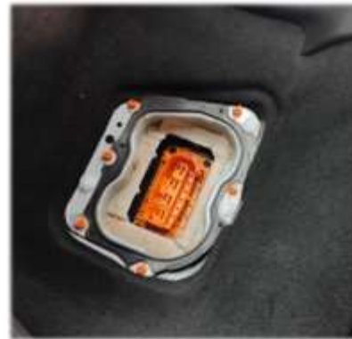
Figura 6. Desconexión de la alta tensión. Fuente: imágenes cedidas por Feu Vert Ibérica, S.A.
