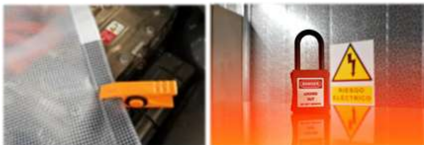
Figura 16. Cubierta aislante, pinza y elemento de consignación.
